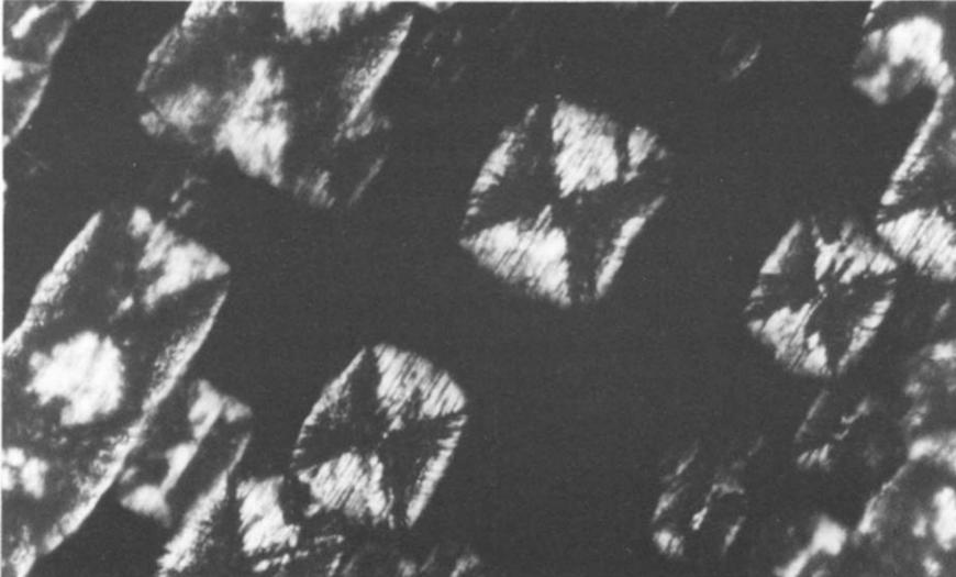
Abb.10 Orientierte Keimbildung bei der thermischen Zersetzung eines Gipseinkristalls unter dem Heitischmikroskop, gekreuzte Polarisatoren, Vergrößerung: 75fach
